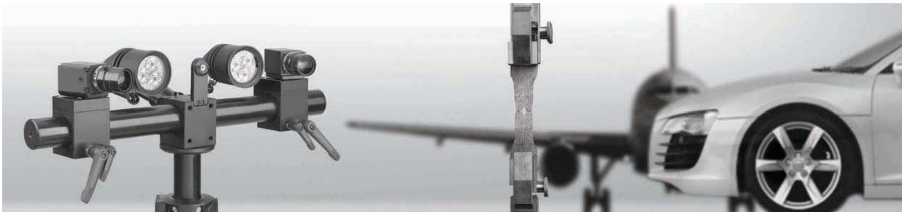
非接触式全场应变测量系统主要采用数字散斑相关方法，结合工业近景拍摄技术，采用工业摄像头，实时采集物体各个变形阶段的数字图像，利用数字图像相关算法进行物体表面变形点的匹配，重建出匹配点的坐标。对位移场数据进行平滑处理和应变信息的可视化分析，从而实现快速、高精度、实时、非接触式的全场变形及应变测量。
